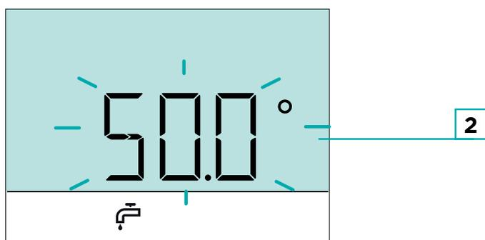
**1** La fonction de chauffage d'eau domestique unique est sélectionnée.
