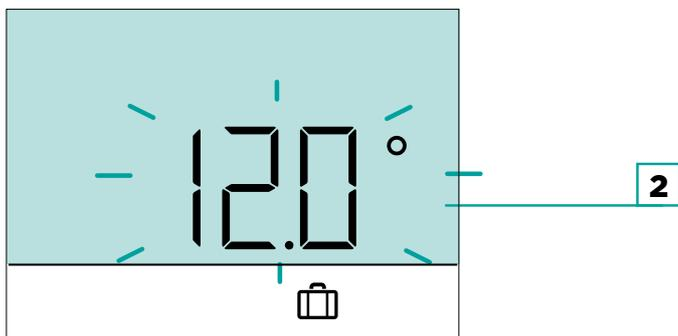
Lorsque la fonction Vacances est activée, il est possible de vérifier ou de modifier les paramètres en appuyant sur les boutons **+** ou **-**.
