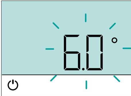
La température pour la protection contre le gel peut être réglée lorsque le contrôleur est éteint.
