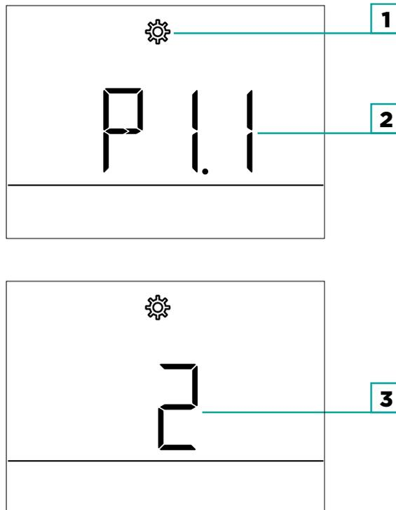
Lorsque vous entrez dans le sous-menu P1, P2 ou S1, vous pouvez parcourir les paramètres avec les boutons **+** et **-**. Confirmez le réglage du paramètre sélectionné en appuyant de nouveau sur le bouton **✓**.
