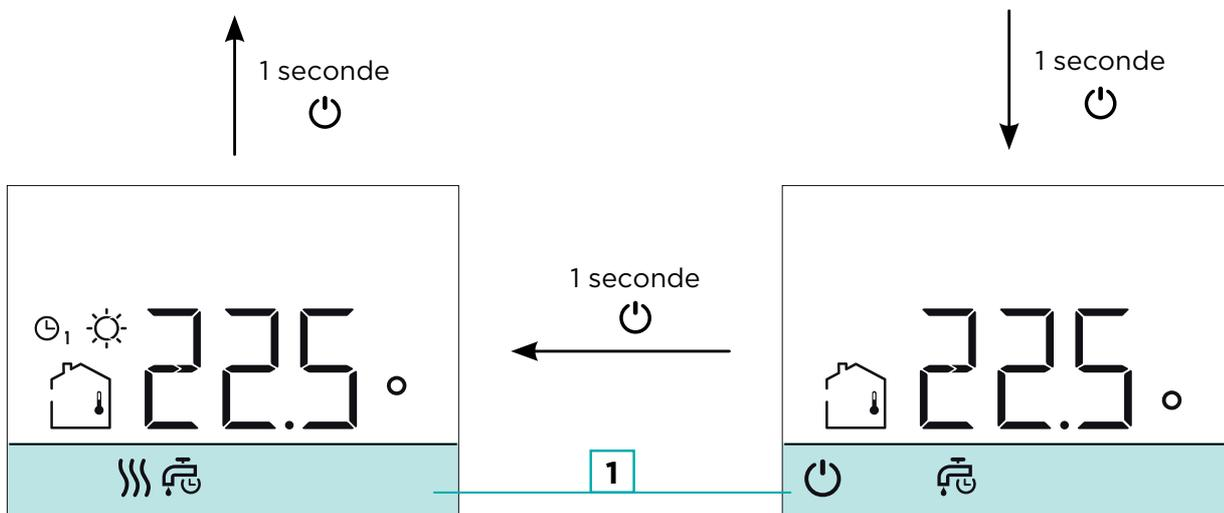
\* Le chauffage ou le refroidissement des pièces et le chauffage de l'eau chaude sanitaire selon le programme temporel sont actifs.
